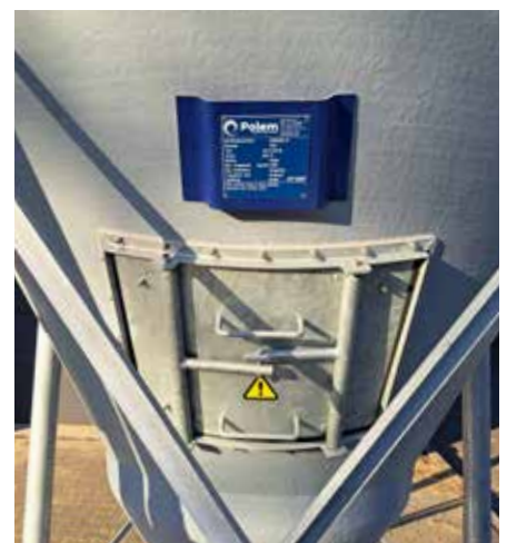
Thermisch verzinkt inspectieluik
