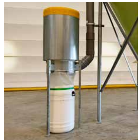
De Air-Cleaner voorkomt stofoverlast
